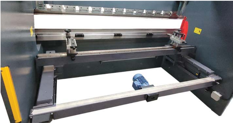
UMS Marka X eksenli \pm 0,1 mm hassasiyete sahip A/C motorlu, arka dayama X=750mm
