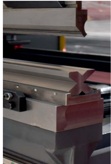
Çok kanallı kalıp için geniş alt tabla
