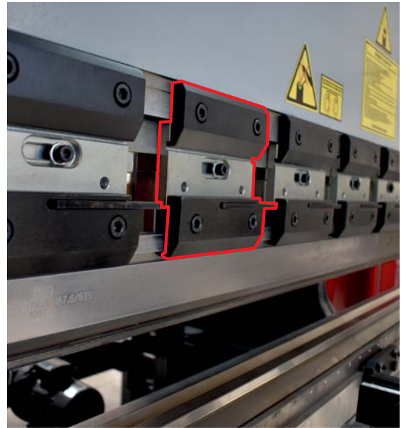
Avrupa Tip promecam (hızlı kalıp bağlama sistemi) EUROSTAMP (İtalya) Marka kalıplar
