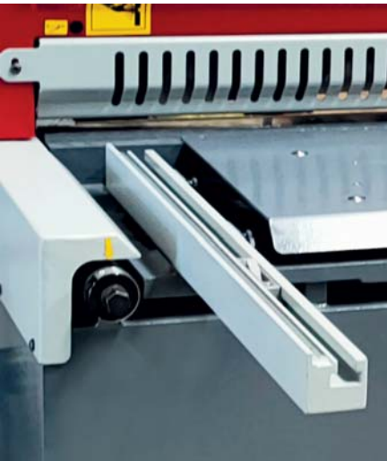
4-5-6 mm Makinelerde T kanallı 1000 mm uzunluğunda stoperli cetvelli gönye ve sentil ayar başlığı
