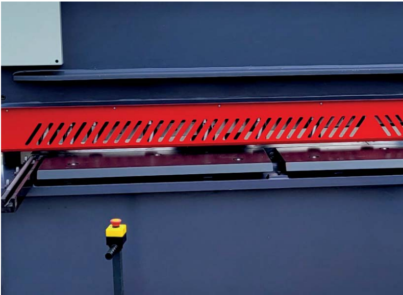
PRO SERİSİ T Kanallı Ve Stoperli Ön Cetvel Ve Bilyalı Saç Sürme Tablası
