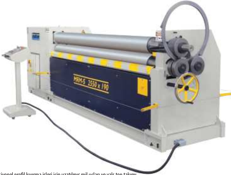
Opsiyonel profil kıvrma işleri için uzatılmış mil uçları ve vals top takımı Optional extended roll shafts for profile bending operation and section bending rolls set
