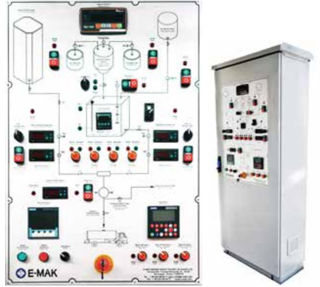
Mimik diyagram üzerinden izlenebilen sıcaklık, seviye ve debi değerleri
