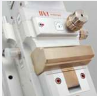
Odağın nozül ucuna odaklanması için X, Y hizalamalı temel modül
