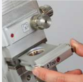
Odaklama merceğini korumak için denetlenen kapak slaydı
