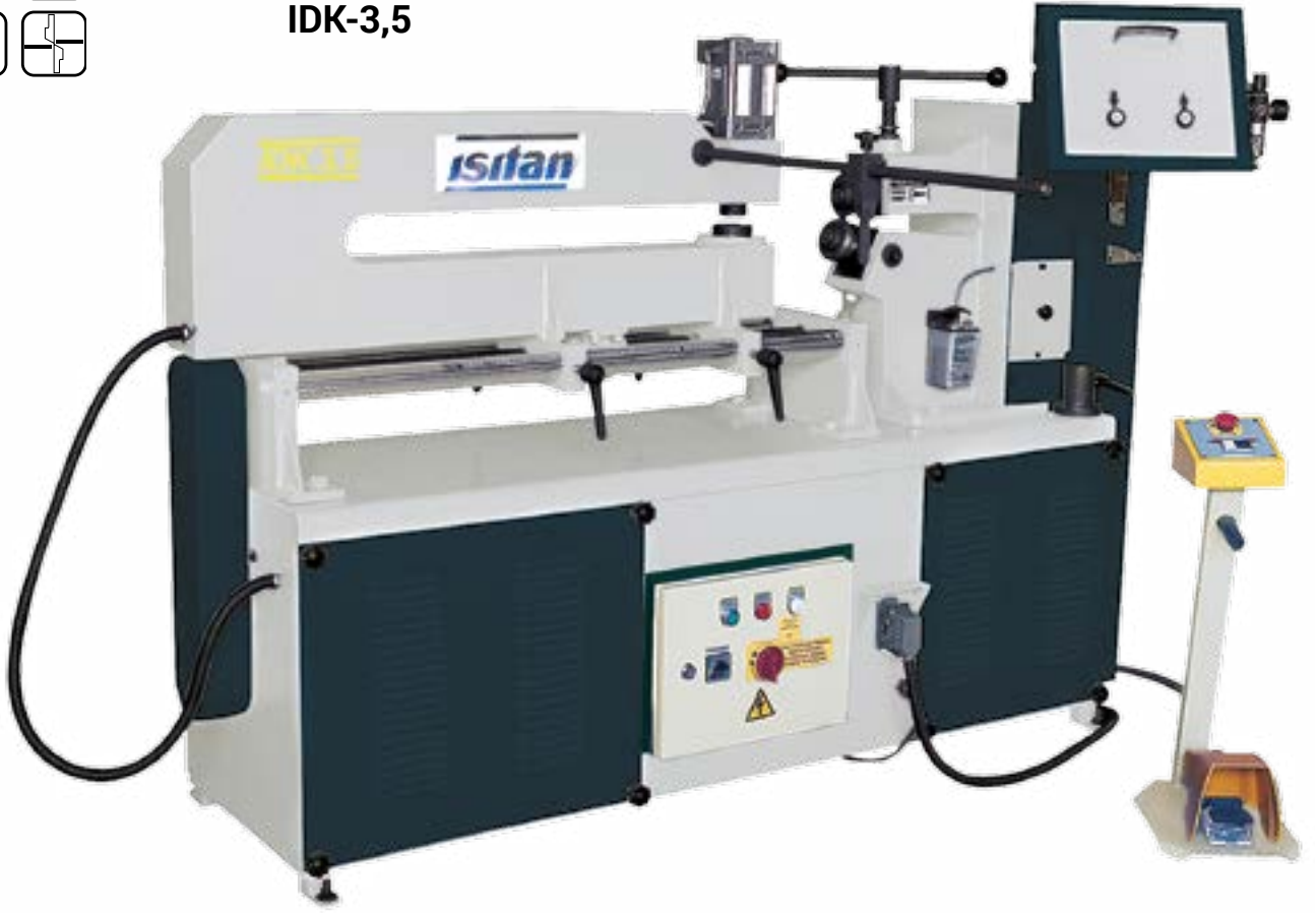
IDK-3,5 Pnömatik Sıkıştırılmalı Daire Kesme Makası Pneumatic Type Circular Cutting Shear
