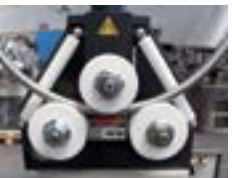
Alüminyum ve paslanmaz kıvrım için özel plastik vals topları Derlin rolls for aluminum and stainless steel
