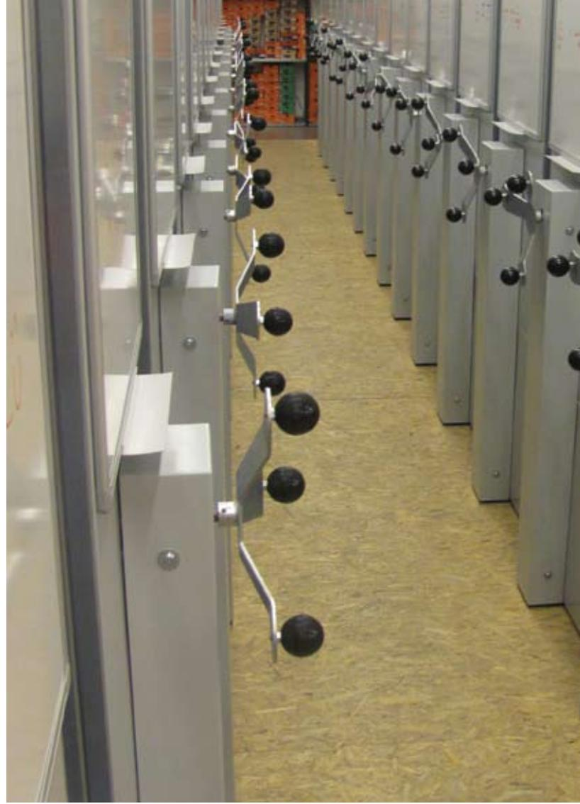
→ Pratik bir çark sistemi ile zincirler ve tekerlekler sayesinde operatör dolaplara gidilecek yön bilgisini iletir. Mobil dolaplar dişli oranları sayesinde çok az güç harcanarak kolayca hareket ettirilebilir.
