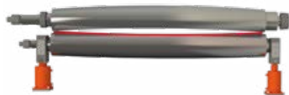
Bükme kalınlığı silindir bombesinden daha kalındır Bending thickness is thicker than roll crowning
