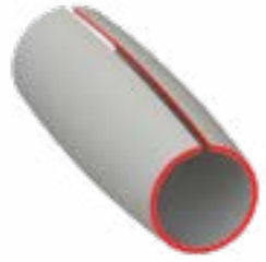
Fıçı bombe bozulması Barrel crowning deformation
