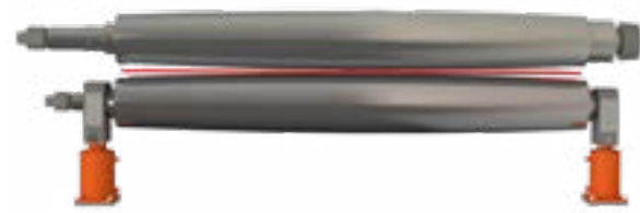
Bükme kalınlığı silindir bombesinden daha incedir Bending thickness is thinner than roll crowning
