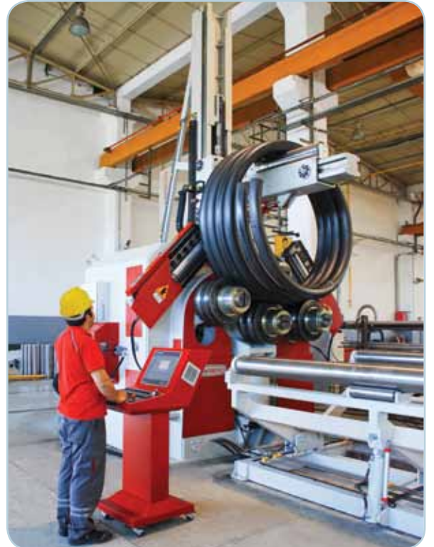
APK244 Hidrolik 4 Toplu Profil Bükme Makinesi (özel üretim) APK244 4 Rolls Hydraulic Profile Bending Machine (special production)
