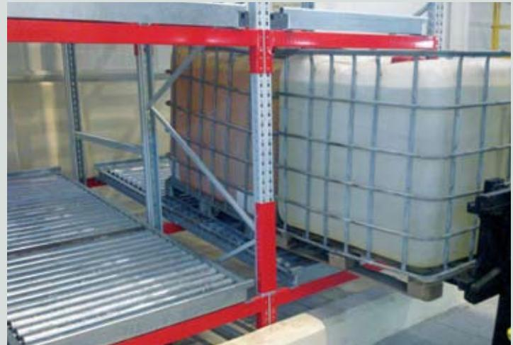
→ Geri itmeli rulolu depo raf sistemi derinlemesine 6 adete kadar paletin depolanmasına izin verir. Her palet rulolar üzerinde diğer paleti iterek sistemin derinliğine doğru yerleştirir.
