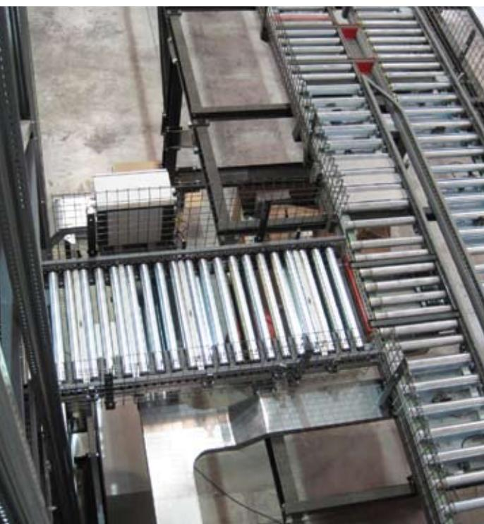
→ Depo ve operatör arasında hızlı ve güvenli bir yöntemle ürünlerin taşınmasını sağlar. Düşük bakım gereksinimi ergonomik ve kompakt tasarımlı ile operasyon maliyetlerinin azaltılmasını sağlayan yüksek randıman gerektiren günlük işlere göre tasarlanmış güçlü bir sistemdir.
