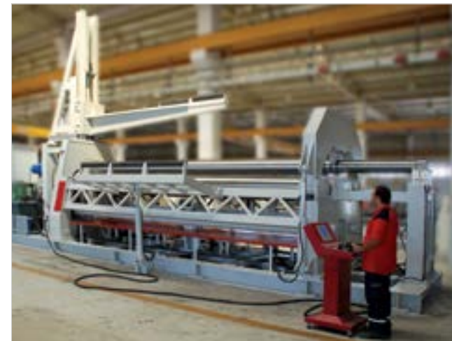
Pre-stress plate bending machine for tube bending Boru üretimi için ön gerilmeli özel silindir makinesi
