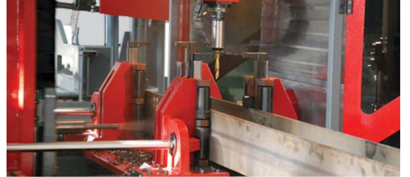
Ayrı bağımsız spindle ünitesi sayesinde profilin üç tarafına aynı anda delik delinebilir
